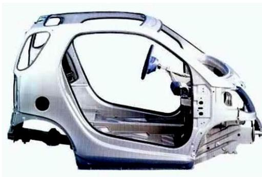
*la gabbia in acciaio che costituisce la struttura resistente della Smart - 1998*
