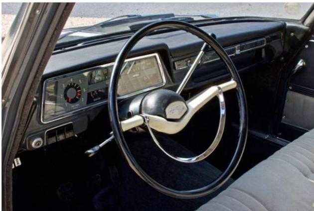
*gli interni della Giulia TI, con panca continua, cambio al volante e strumentazione lineare - 1962*
