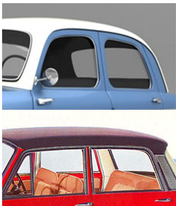
esempi di bordo finestrino su Fiat 1100 e 1200 Granluce in alto: bordo finestrino della 1100 in tinta vettura, ricavato direttamente nella portiera, stampata in un sol pezzo sotto: bordo finestrino della 1200 Granluce, in profilato metallico sagomato e cromato
