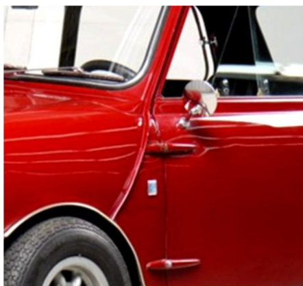
particolari della carrozzeria della Mini Minor: le cerniere esterne della portiera, la costola a vista della saldatura
