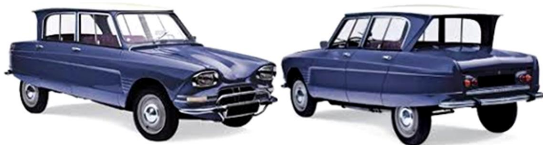
vista frontale e da retro della Citroen Ami 6, notare il lunotto ad inclinazione rovescia - 1961
