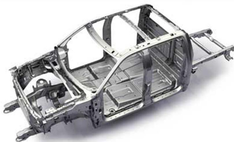
esempio di scocca a resistenza differenziata di un moderno Suv
