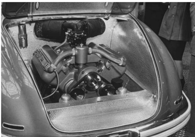
l'otto cilindri a V posteriore dell'Isotta Fraschini 8C Monterosa - 1947
