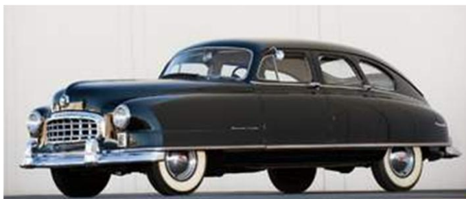
esempio di carrozzeria ponton: Nash Ambassador - 1950
