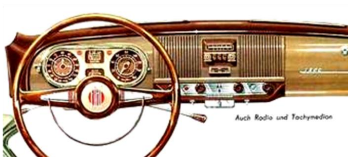
plancia di Fiat 1400: notare oltre il volante la leva del cambio
