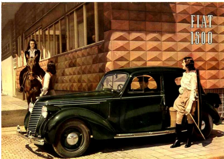
Fiat 1500 del dopoguerra, con i fanali separati dai parafranghi - 1948
