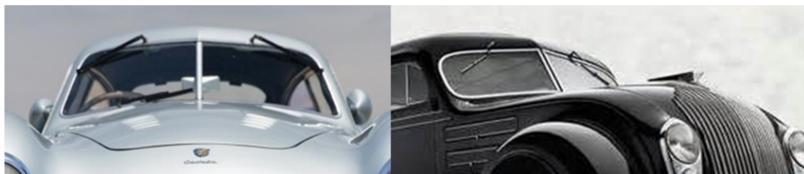
due esempi di parabrezza sdoppiato a spartivento – anni quaranta
