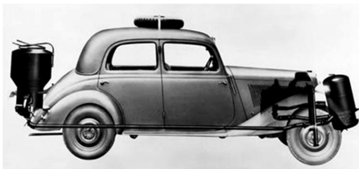
impianto a gassogeno installato su una Mercedes 170 negli anni della guerra
