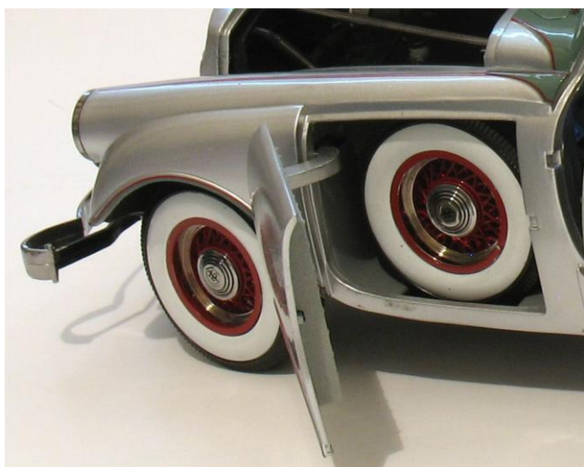
l'ingegnosa disposizione della ruota di scorta della Silver Arrow, celata nel parafrango - 1933
