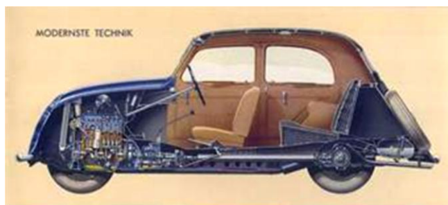
spaccato della Fiat 508 C Balilla 1100, con evidenziato il vano bagagli dietro ai sedili posteriori - 1937
