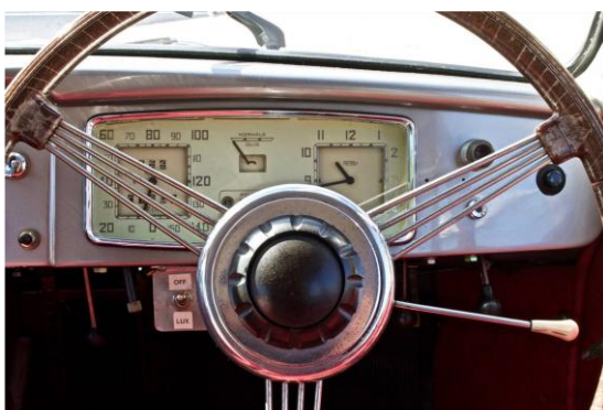
plancia di una Lancia Aprilia con evidenza della leva del cambio al volante – anni quaranta
