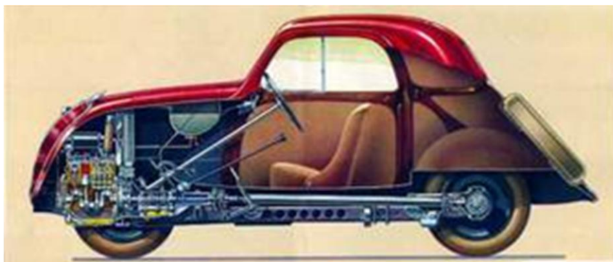
spaccato della Fiat 500 che ne evidenzia l'abitabilità ed il vano bagagli - 1936
