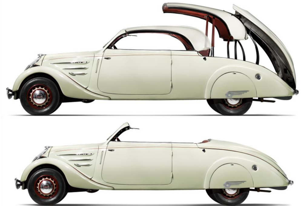
Peugeot 402 Eclipse ed il ripiegamento del suo tetto rigido - 1938
