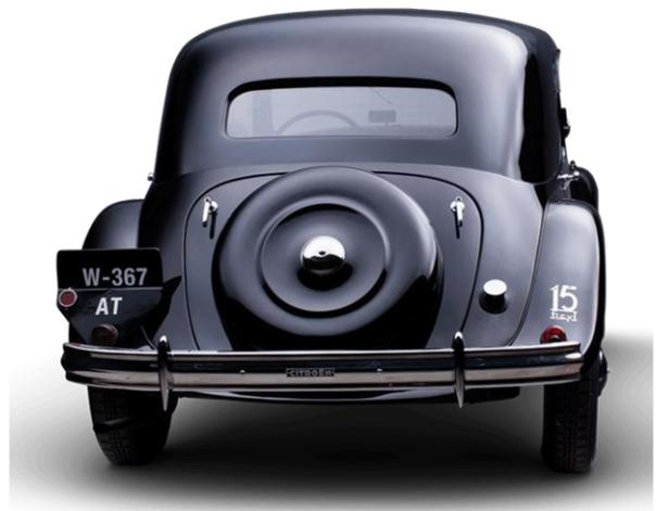
*il bagagliaio della Traction Avant, con ruota di scorta esterna e vano bagagli nell'abitacolo - 1934*
