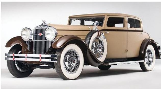
*esempi di carrozzeria elastica tipo Weymann: utilitaria Fiat 509 guida interna e vettura di lusso americana, pure a guida interna, Stutz – anni venti*
