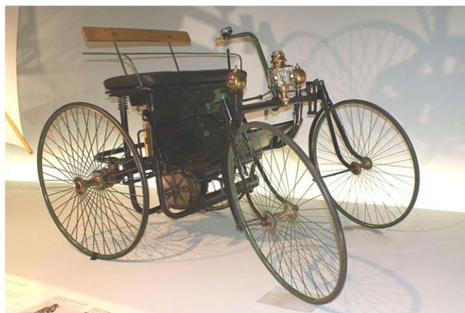
*la Daimler bicilindrica biposto a quattro ruote - 1889*
