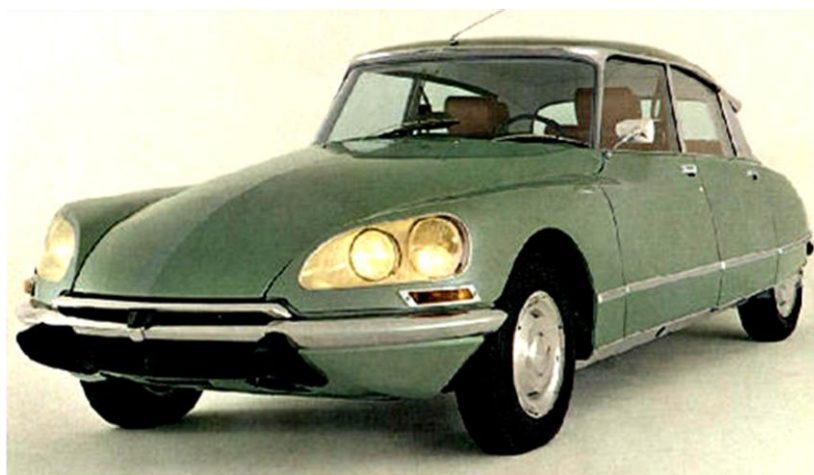
ultima serie della DS con i fari incassati sotto una copertura trasparente
