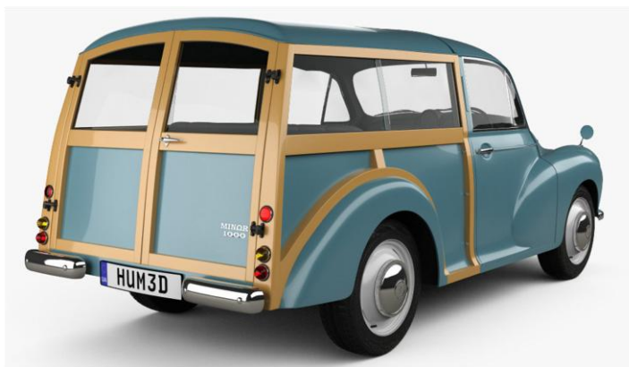
Morris Minor, con profili lignei su carrozzeria in acciaio - 1952
