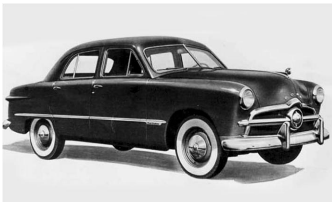
esempio di carrozzeria ponton: Ford Fordor - 1950
