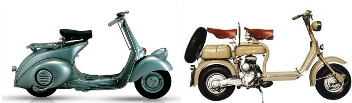
la Vespa 98 (1946), con il motore sotto la sua carenatura e la Lambretta D (1952), con il suo telaio tubolare ed il cilindro a vista
