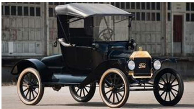
una Ford T spider del 1910 – notare che cofano, fari, abitacolo, sono tutti oggetti separati ed accostati
