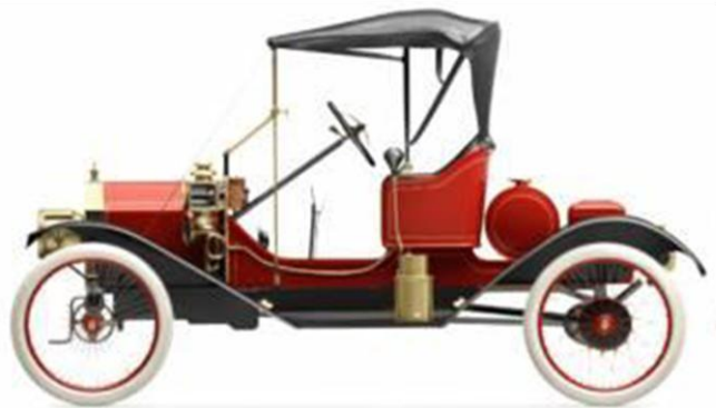
esempio di serbatoio a vista installato dietro al sedile del conducente di una Ford T spider – anni dieci del 'novecento
