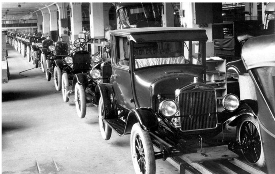
catena di montaggio mobile delle vetture Ford modello T - 1918
