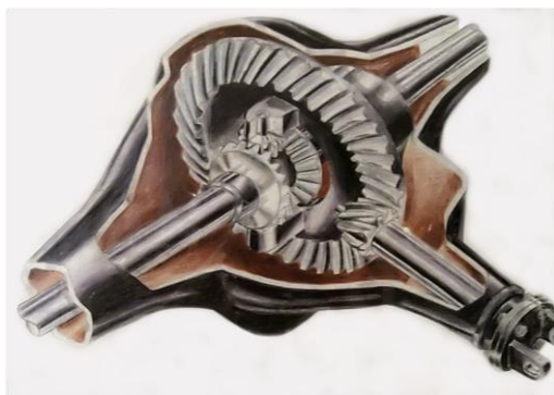
spaccato di ingranaggio differenziale
