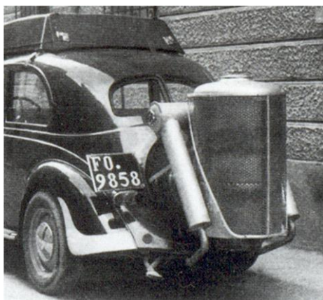
gassogeno per automobile - 1937
