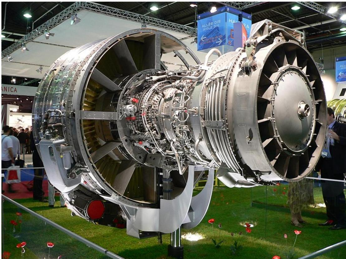
*turbofan General Electric CFM56 – notare le ventole dei primi stadi del compressore che spingono parte dell'aria captata all'esterno della camera di combustione – anni 80*
