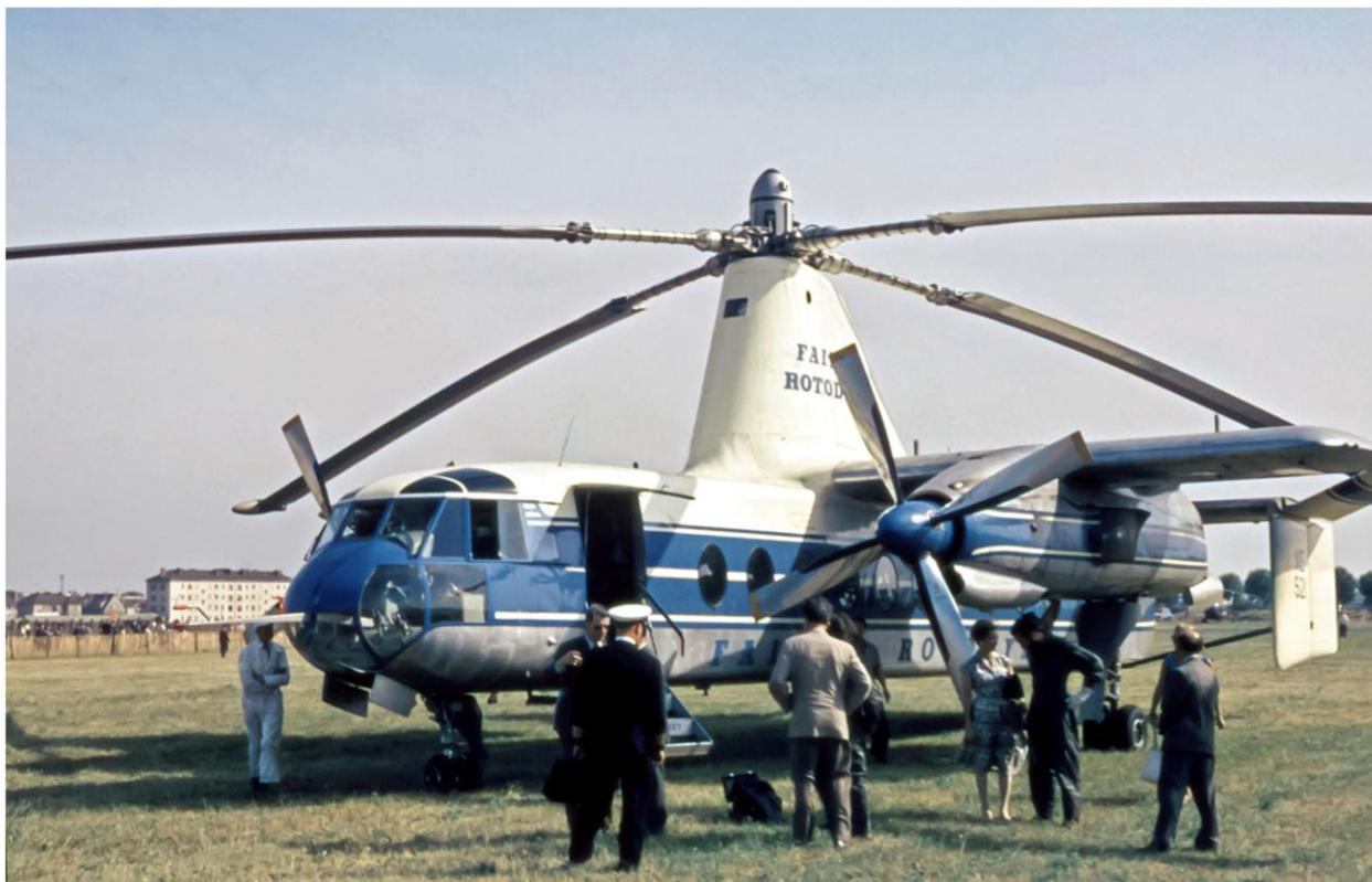
composito inglese Fairey Rotodyne, dotato di ampio rotore e di due motori con elica per il volo orizzontale – 1957
