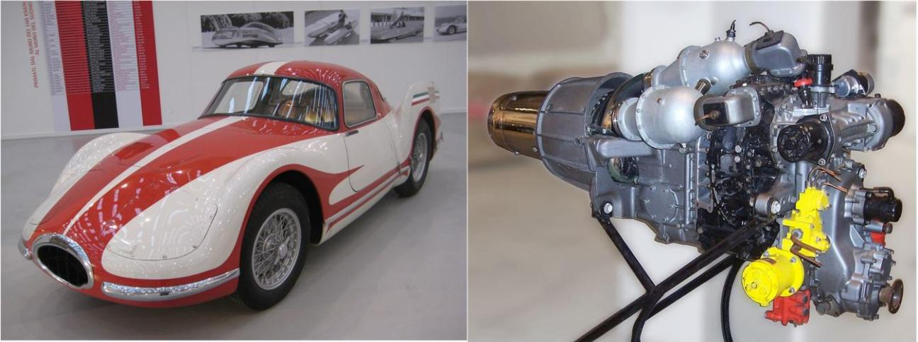
Il coupè Fiat a turbina ed il suo propulsore con compressore centrifugo installato sotto il cofano della vettura - 1954
