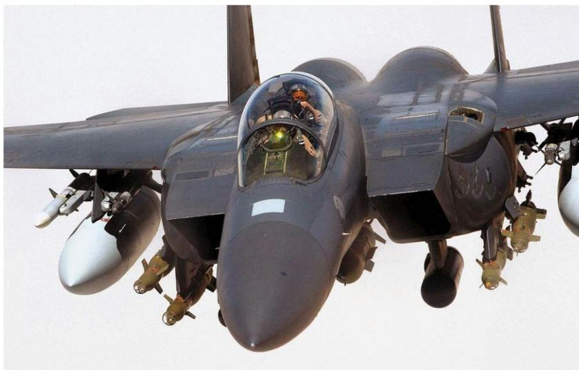
*Fast Packs, visibili come rigonfiamenti della fusoliera lateralmente alla presa d'aria dinamica del turbofan dell'F-15 Eagle - 1974*
