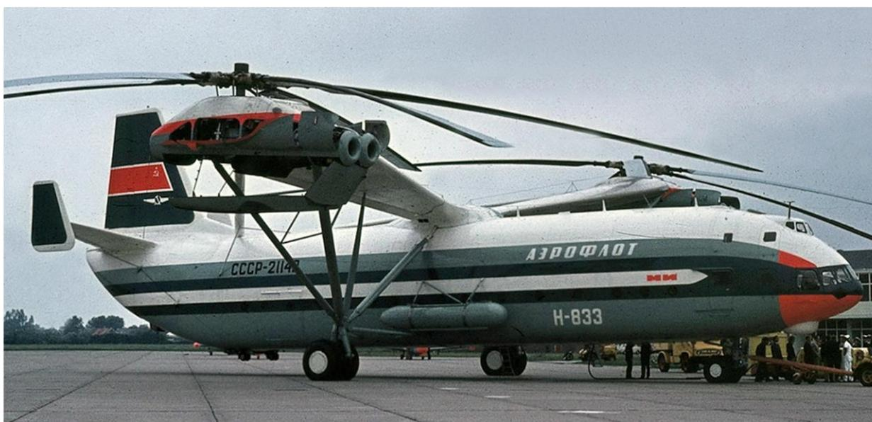
*elicottero sovietico Mil Mi-12, attualmente il più grande del mondo, dotato di due rotori, propulsi con 4 turboshaft – 1968*
