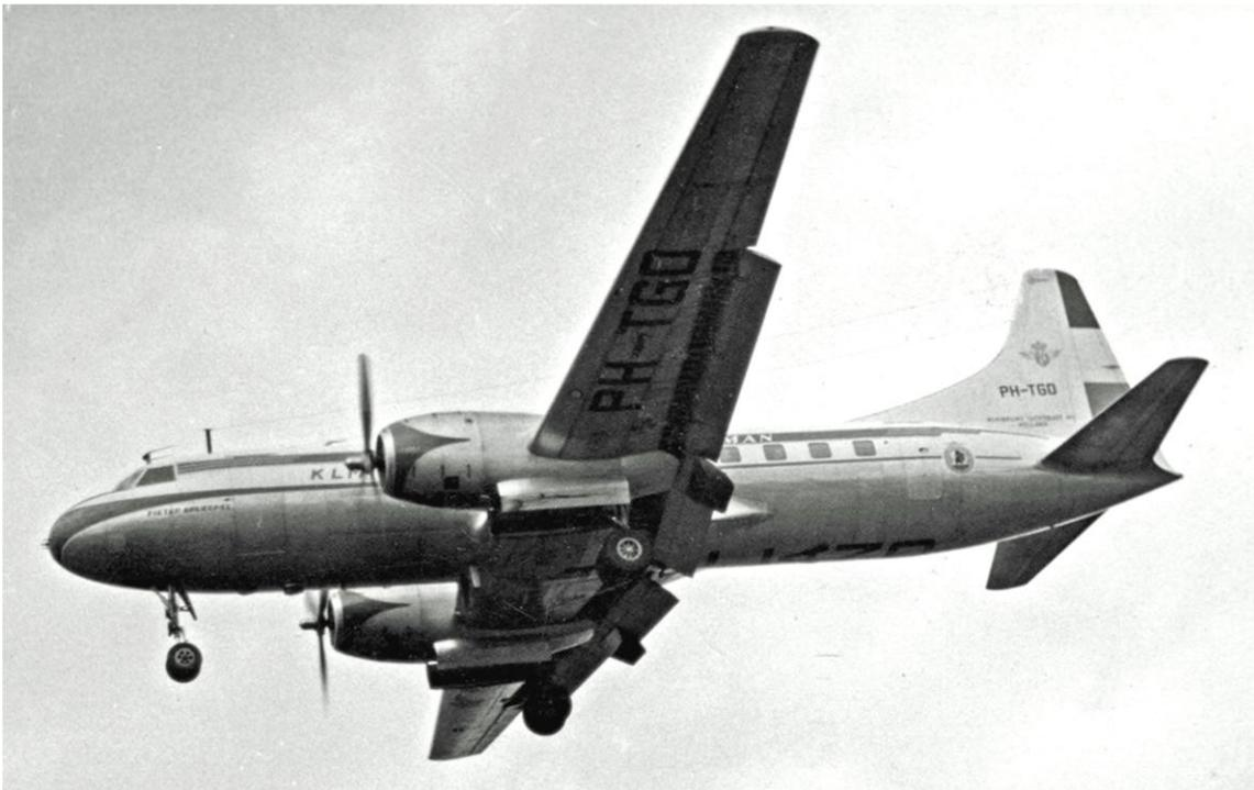
*bimotore a pistoni per corto-medio raggio Convair Liner con il suo carrello tricycle anteriore– 1950*
