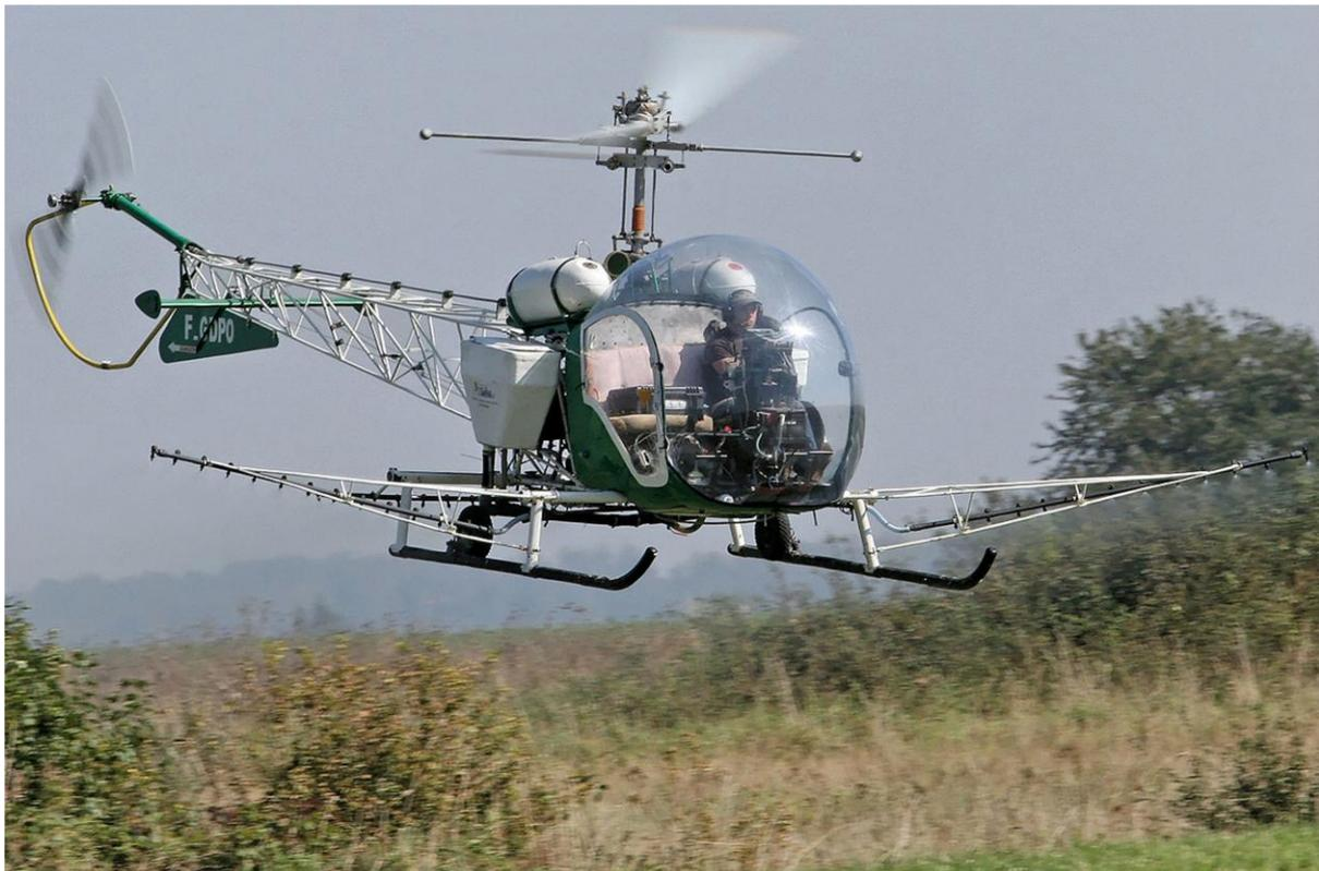
*elicottero americano Bell 47 per uso agricolo, con serbatoi per pesticidi chimici e sistemi d'irrorazione*
