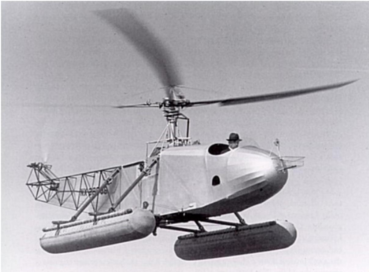
*Igor Sikorsky ai comandi del suo VS-300, provvisto di galleggianti per prove di discesa in acqua - 1942*
