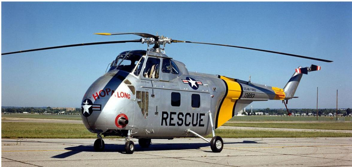
*elicottero Sikorsky S-55, in versione per la Guardia Costiera U.S.A. - 1947 - Il motore stellare Pratt & Whitney si trova sotto la bombatura anteriore della prua della fusoliera, da cui esce il tubo di scappamento*
