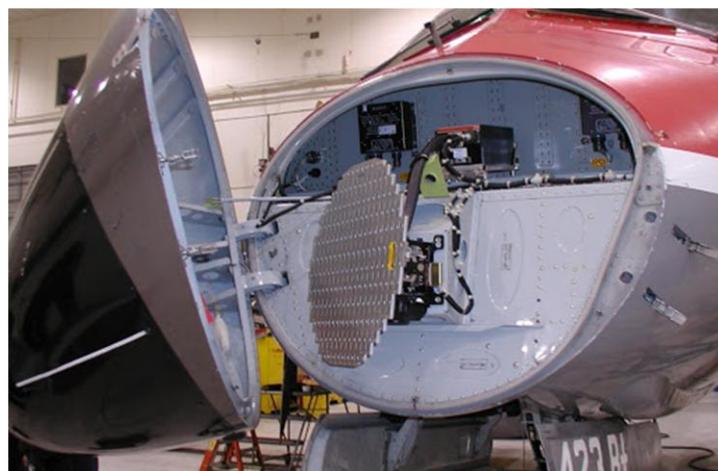
*esempio di musetto di un aeroplano da trasporto passeggeri che contiene un radar meteorologico*
