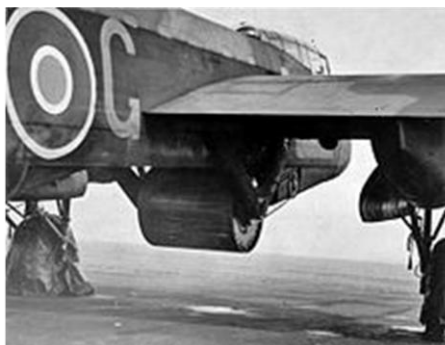
bomba cilindrica anti-diga ,installata sotto il ventre di un Lancaster – 1943
