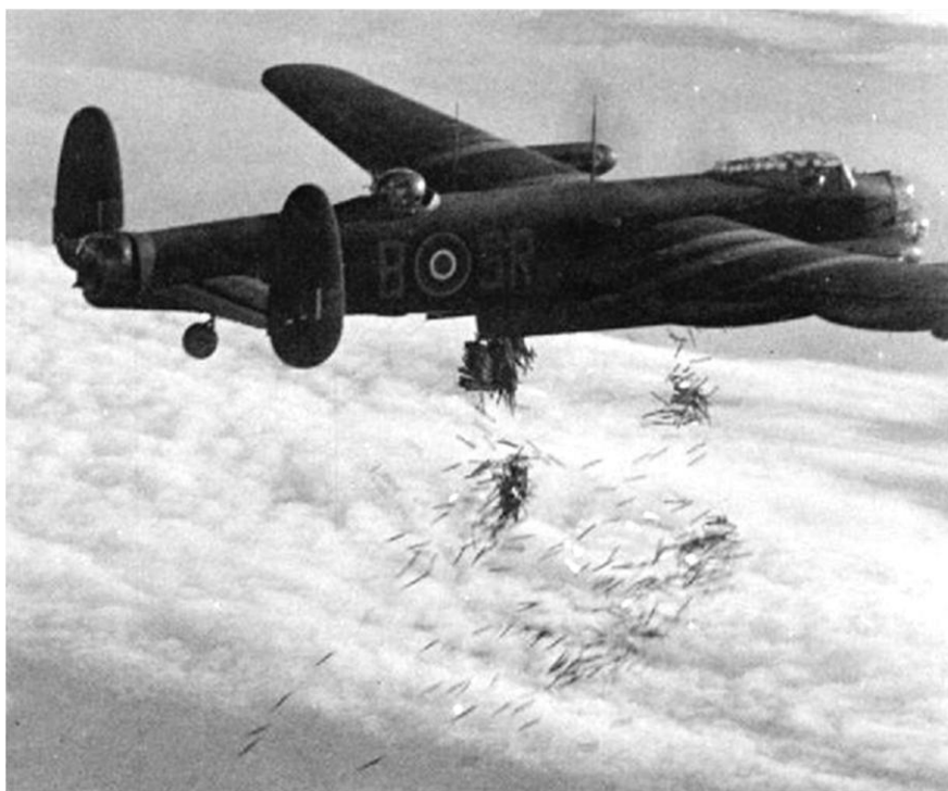
Avro Lancaster mentre dissemina nell'aria striscioline di alluminio – 1943
