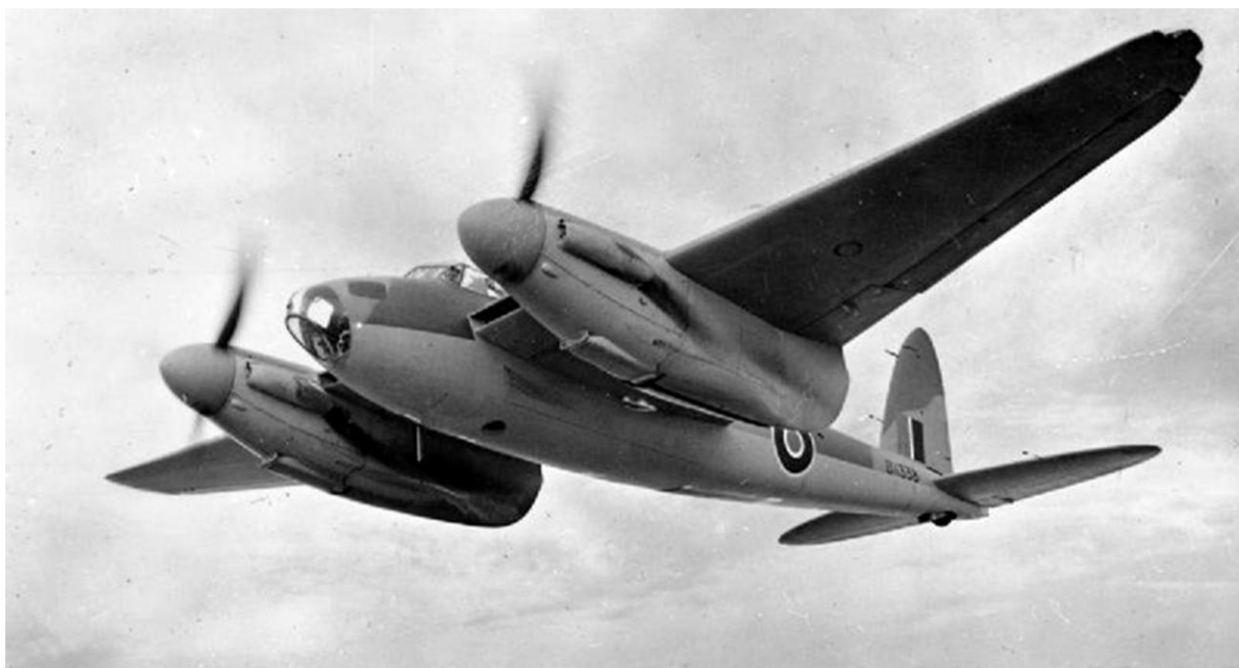
cacciabombardiere inglese bimotore De Havilland Mosquito (la cellula è quasi completamente lignea) – 1942
