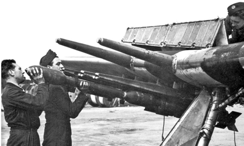
installazione di razzi controcarro su di un cacciabombardiere britannico Hawker Typhoon - 1944
