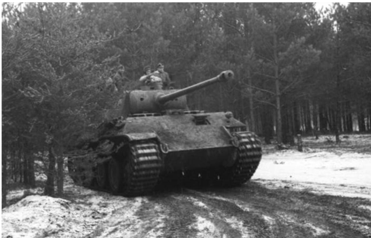
carro armato tedesco Panther (1944) – notare il cingolo particolarmente largo
