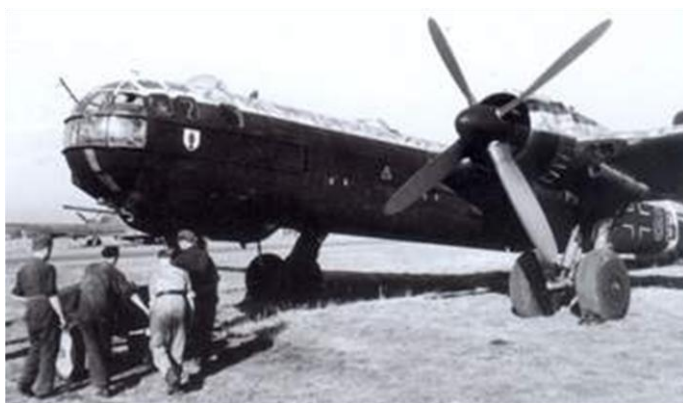
bombardiere tedesco Heinkel He 177 con 4 motori accoppiati in tandem e due eliche – 1943
