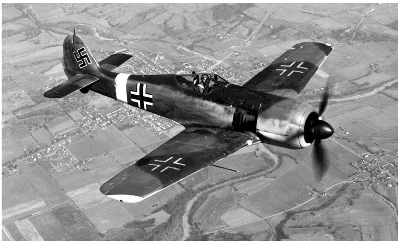
aeroplano da caccia tedesco Focke Wulf FW 190, con motore stellare BMW 801 – 1942
