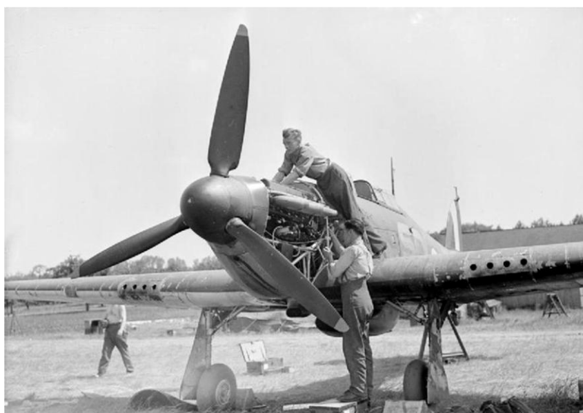
caccia inglese Hawker Hurricane 2D, dotata di 8 mitragliatrici (notare i quattro fori per semiala corrispondenti alle posizioni delle mitragliatrici)
