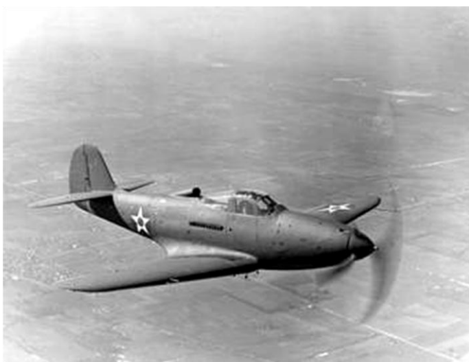
caccia americano Bell P-39 Airacobra – 1942 (notare i collettori di scarico del motore in posizione centrale)
