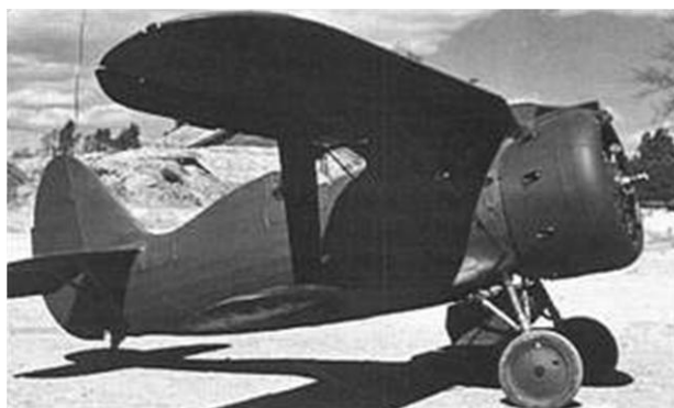
biplano sovietico da caccia Polikarpov I-153 – 1941 notare il carrello retrattile
