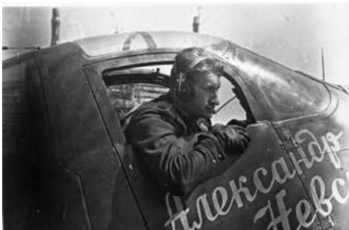
uno dei Bell P-39 forniti all'U.R.S.S. – 1942 (notare il portello d'ingresso in cabina di tipo automobilistico)
