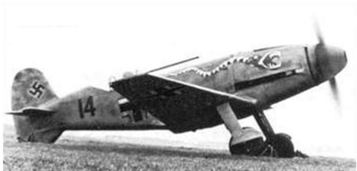
*aeroplano per primato di velocità Messerschmitt Me 209*
