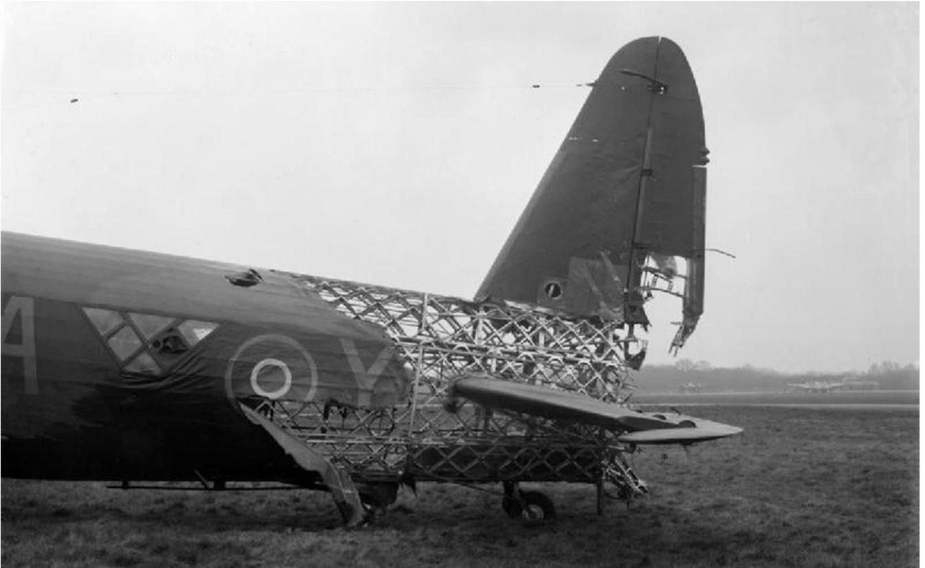
*coda di un Vickers Wellington danneggiata in combattimento, in cui si notano la struttura geodetica ed il rivestimento in tela*
