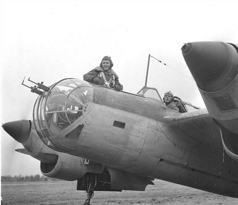
particolare della cabina di un bimotore sovietico Tupolev SB-2 (1937)
