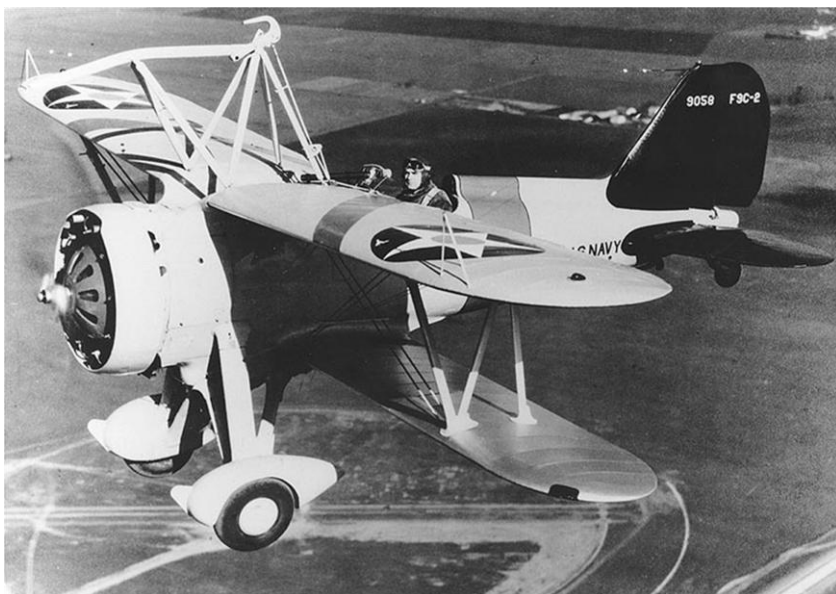
il Curtiss F-9C della US Navy – notare il sistema di aggancio all'aeronave
