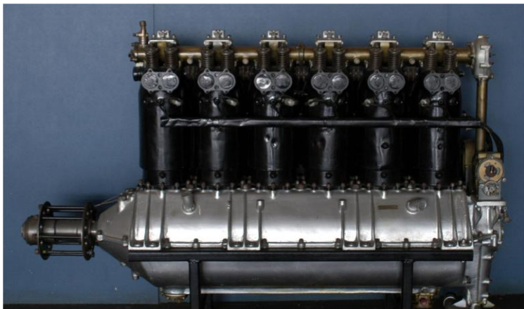
motore a 6 cilindri FIAT A 12 – potenza 250 CV - 1918
