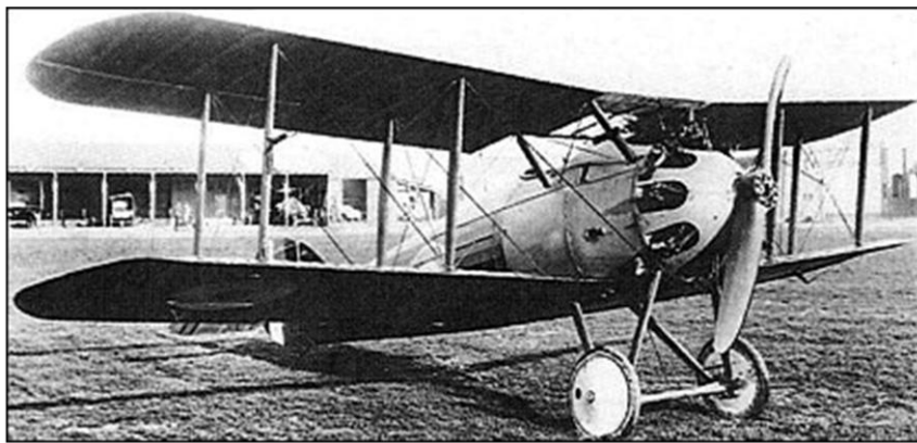
motore stellare fisso a 9 cilindri Bristol ABC Dragonfly su Spwith Dragon - 1918
