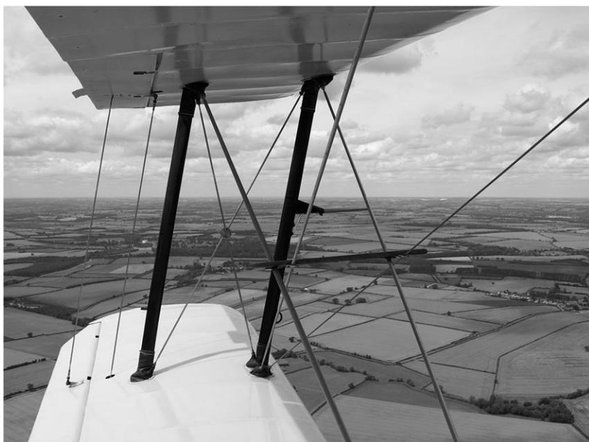
*esempio di controventatura di un biplano - in evidenza: montanti e tiranti*
