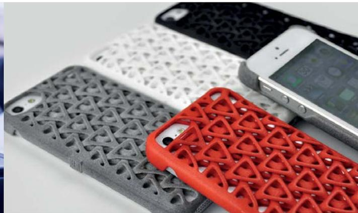
Il materiale utilizzabile è sempre una resina termoplastica (Pla, Abs, Petg e altre ancora), che si ammorbidisce quando esposta al calore e che ha una resistenza meccanica limitata. Perciò non è realistico pensare di riprodurre copie di elementi in metallo, oppure parti da sottoporre a calore e sforzi meccanici intensi.
