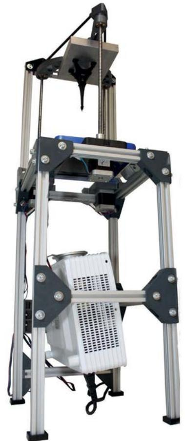
Sla-Dlp impiega una resina liquida indurita dalla luce di un proiettore Dlp.
