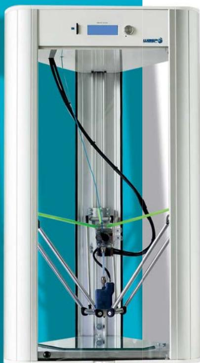
Wasp DeltaWasp 20 40 ha un volume di stampa cilindrico alto 40 cm.
