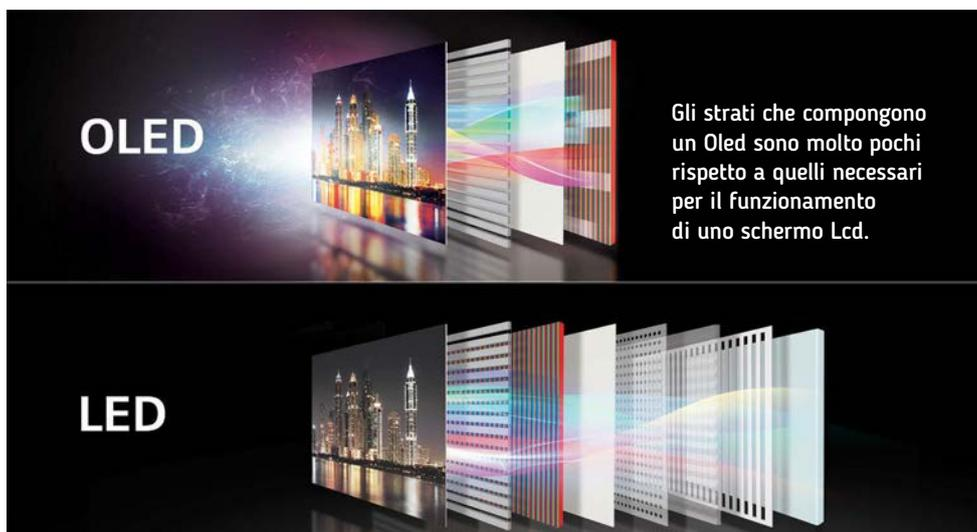
Gli strati che compongono un Oled sono molto pochi rispetto a quelli necessari per il funzionamento di uno schermo Lcd.
